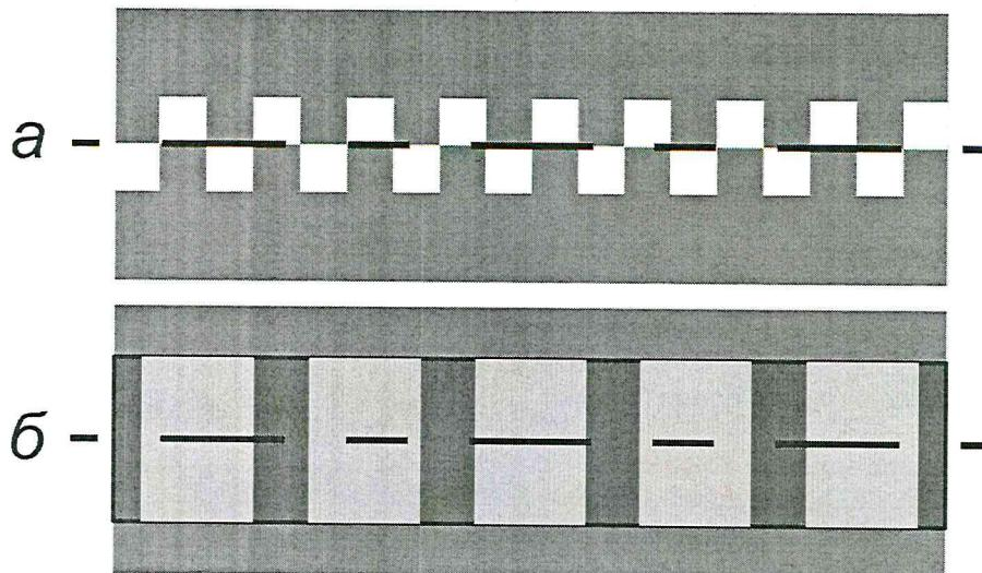
а – для горизонтальной разметки в виде сплошной одиночной полосы (наносимой поперек оси автомобильной дороги); б – для горизонтальной разметки в виде полосы из квадратов (расположенных в шахматном порядке), в виде сплошных полос (расположенных поперек оси искусственной неровности)
