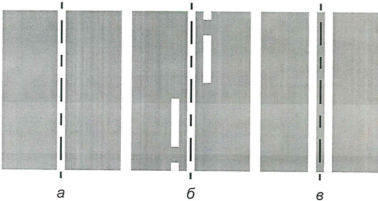
*а* – для горизонтальной разметки в виде сплошных и прерывистых одиночных линий; *б* – для горизонтальной разметки в виде сочетания сплошной одиночной линии и прерывистой одиночной линии с соотношением длины штриха к расстоянию между штрихами, равному 3:1; *в* – для горизонтальной разметки в виде двойной сплошной или прерывистой линии
