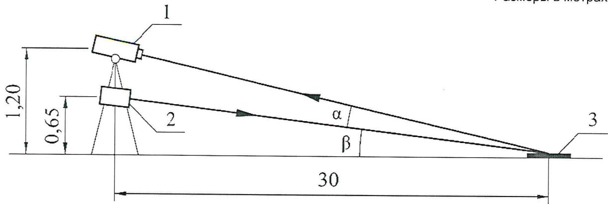
Рисунок 11 – Условия определения удельного коэффициента световозвращения горизонтальной дорожной разметки
