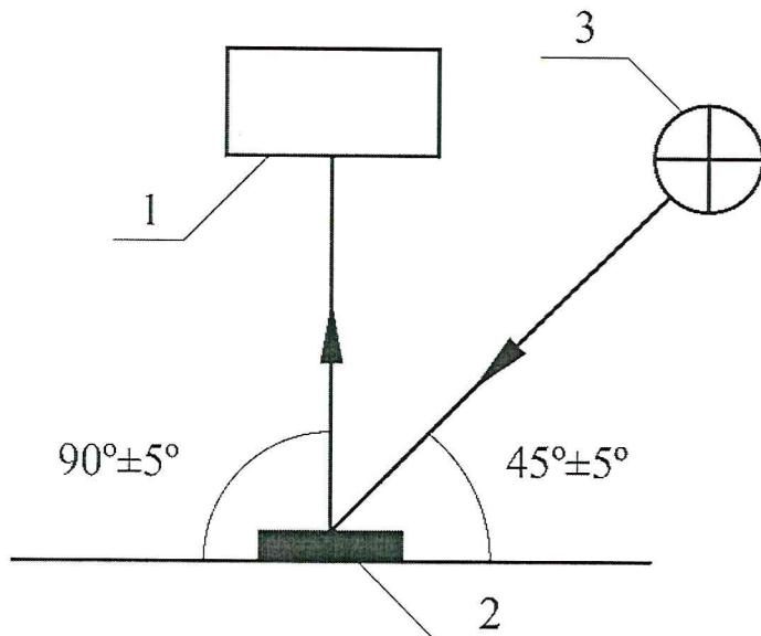
1 – Спектрофотометр или колориметр для измерения координат цветности, спектрофотометр, колориметр или яркомер для измерения коэффициента яркости; 2 – дорожная разметка;
