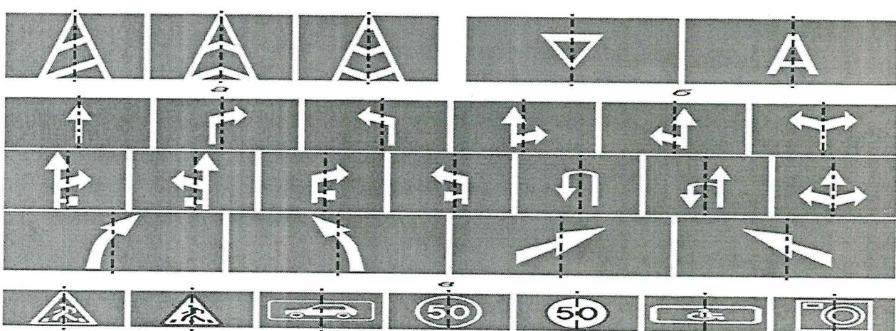
*а* – для горизонтальной разметки в виде наклонных полос (включая ломанные), ограниченных сплошными одиночными линиями; *б* – для горизонтальной разметки в виде равнобедренного треугольника, обращенного вершиной к водителю, не окрашенного внутри и для горизонтальной разметки в виде изображения буквы «А»; *в* – для горизонтальной разметки в виде стрел; *г* – для горизонтальной разметки в виде изображения дорожного знака
