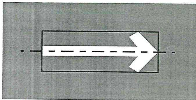
Рисунок 4 – Схема расположения осей и внешних границ горизонтальной разметки в виде стрелки
