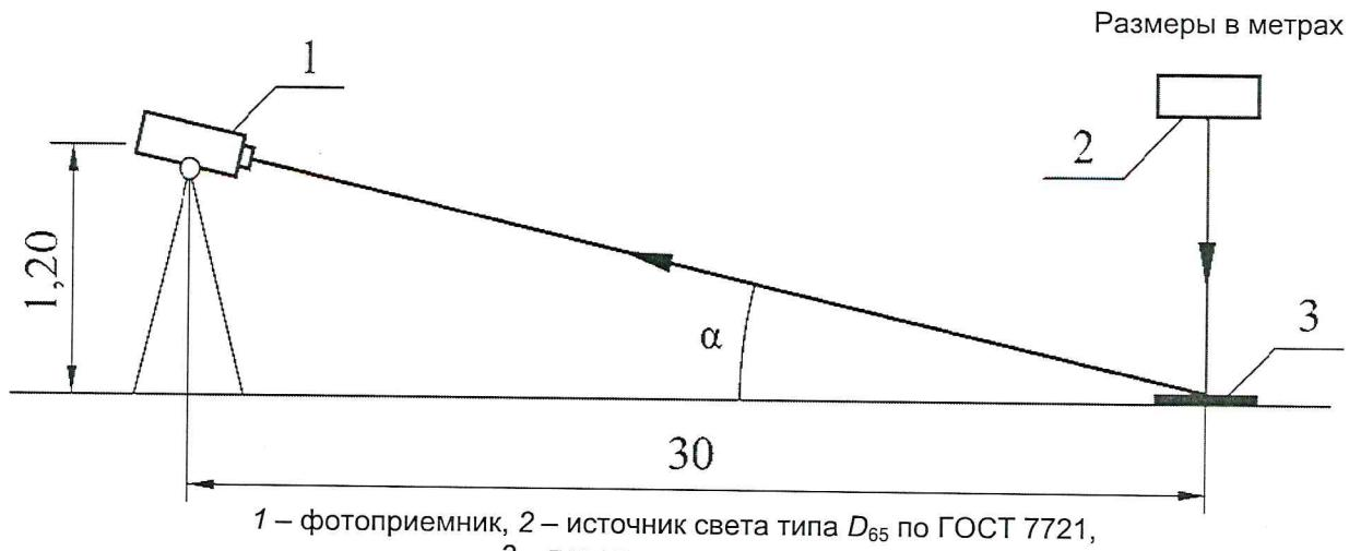
Рисунок 12 – Условия определения удельного коэффициента светоотражения при диффузном дневном или искусственном освещении
